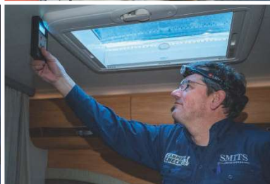
♦ De vochtmeting brengt geen lekkage aan het licht.
